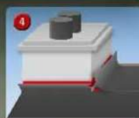
4 屋顶防水卷材在烟囱连接区域中的密封粘接
