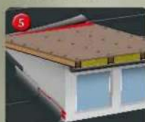
5 屋顶防水卷材和屋顶连接区域的粘接和密封
