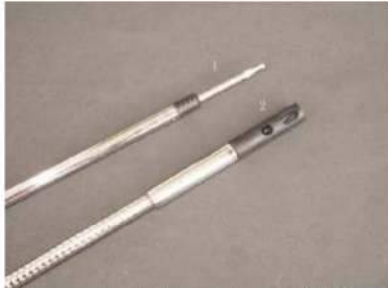
图 3.11: 热球探头 (1), 热线探头 (2)
