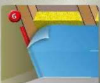
6 墙体连接区防潮层的粘接和密封
