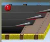
1 屋顶防水卷材交叠区域的粘接和密封
