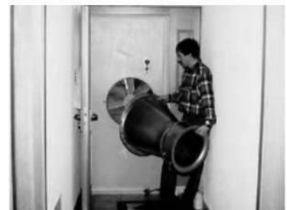
图 2.6: 第一批风门测量仪器很笨重。1987 年利用这套风门在瑞士材料实验所 EMPA 进行了测量。(照片: 质量控制专家工作组, 德本多夫/瑞士)
