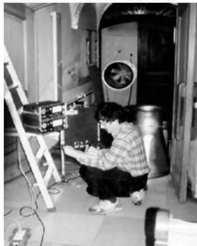
图 2.6: 第一批风门测量仪器很笨重。1987 年利用这套风门在瑞士材料实验所 EMPA 进行了测量。(照片: 质量控制专家工作组, 德本多夫/瑞士)
