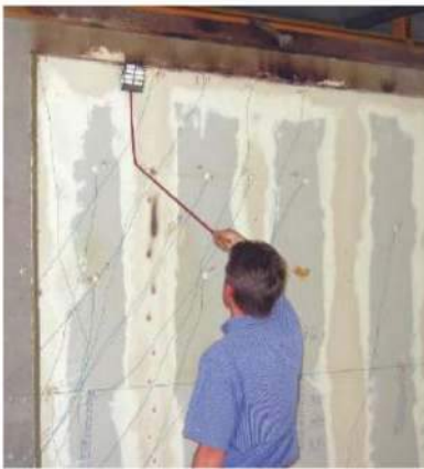
图 1.7: 按照 DIN4102-2 用棉花球做着火试验, 检查房间分隔墙的消防气密性。
