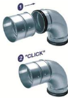
图 5.34: 最高密封性等级 D 级的螺旋风管系统自锁式插接安装。[来源: Lindab 有限公司]
