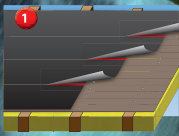
1 衬底搭接部位的粘接和密封
