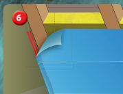
6 墙体防水雨布的粘接和密封
