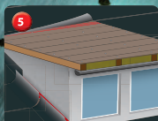
5 天窗连接区域衬底的粘接和密封
