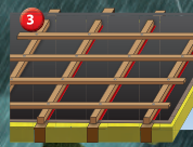
3 用于密封固定挂瓦条或顺水条的处夹锚和钉孔区域
