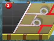
2 打底剂, 用于提高丙烯酸、丁基或是沥青密封胶带的粘接剂
