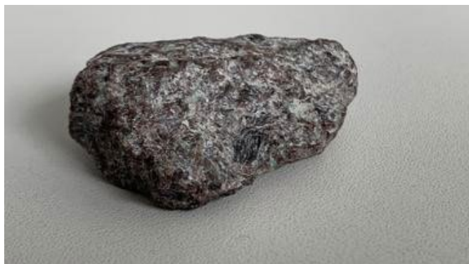
电-热储能装置所用的火山岩石块 图片来源: Sven Rieken
