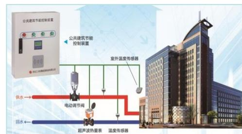
智慧热网技术既可以实现整个热网的自动化、智能化运行调控，也可以实时监测热网热能消耗情况、或某一楼栋供热数据和所有网热用户供暖质量。
