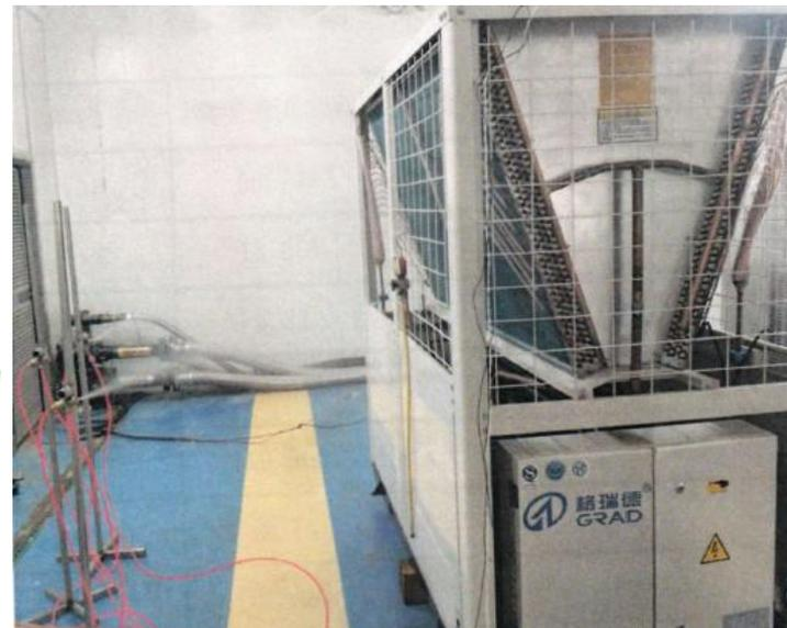
格瑞德风冷机组喷雾冷却测试
