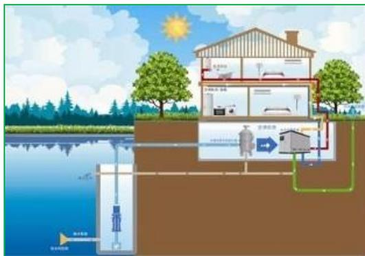
**B、水源热泵：**以水作为热源或冷源，利用少量电能驱动热泵机组，将低品位热能转变为高品位热能，为室内供热或供冷。水温对COP影响显著。
